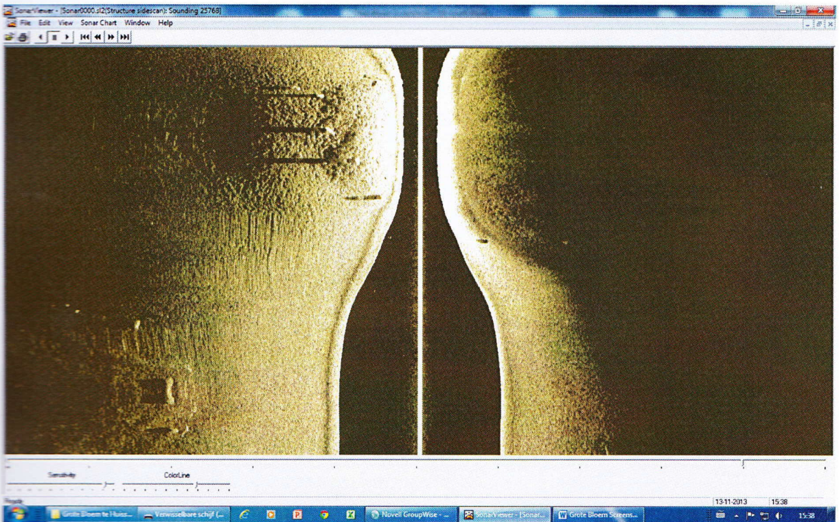
Nogmaals oude betonpalen met de harde schaduw aan de achterzijde. De schaduw wordt veroorzaakt doordat de StructureScan niet achter de palen kan kijken.
